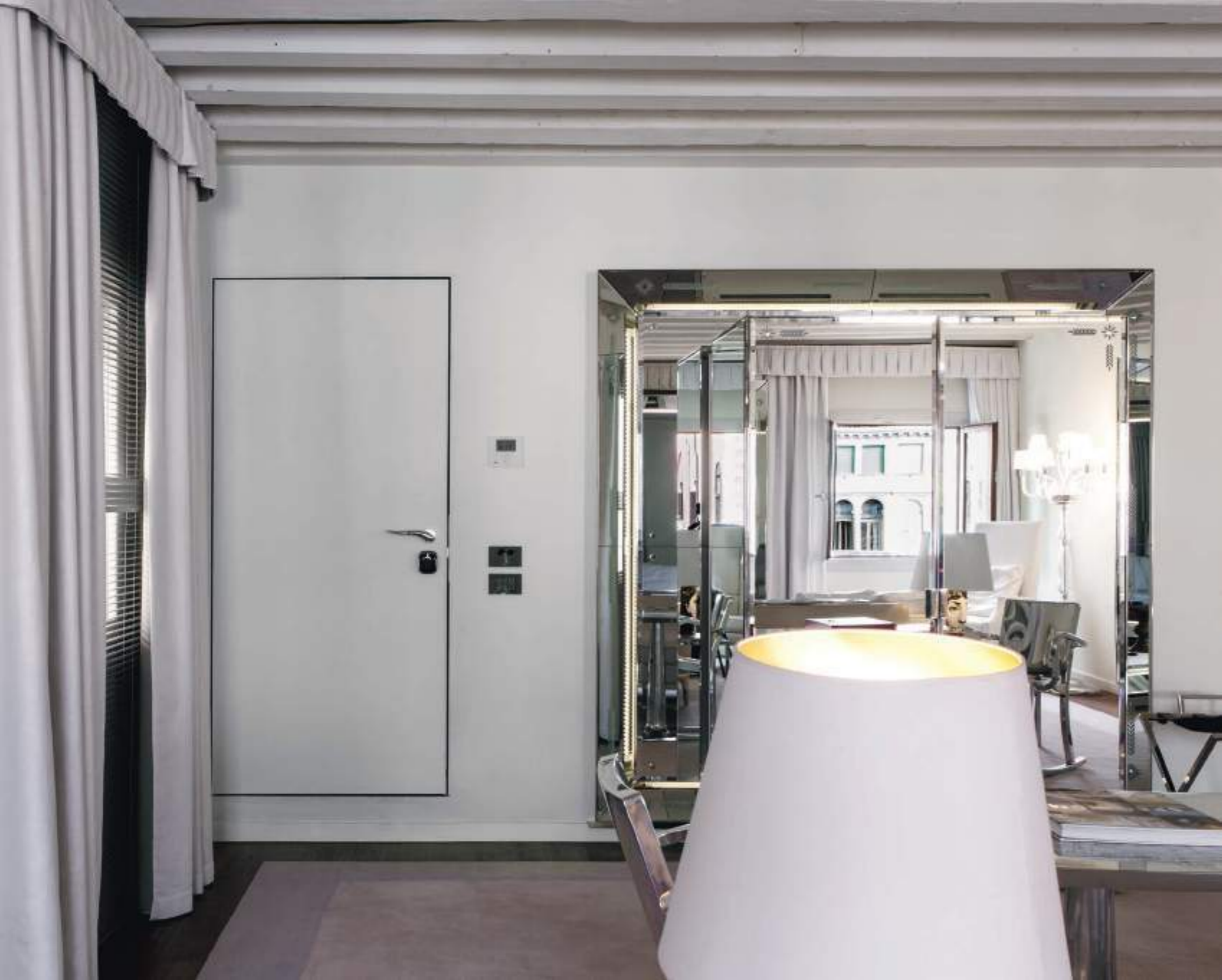
Esterno: Linea Piano laccato Antracite poliester lucido Interno: Linea Piano finito con pittura murale in loco Porta con kit tagliafuoco EI30 e applicazione sistema di chiusura Hotel
