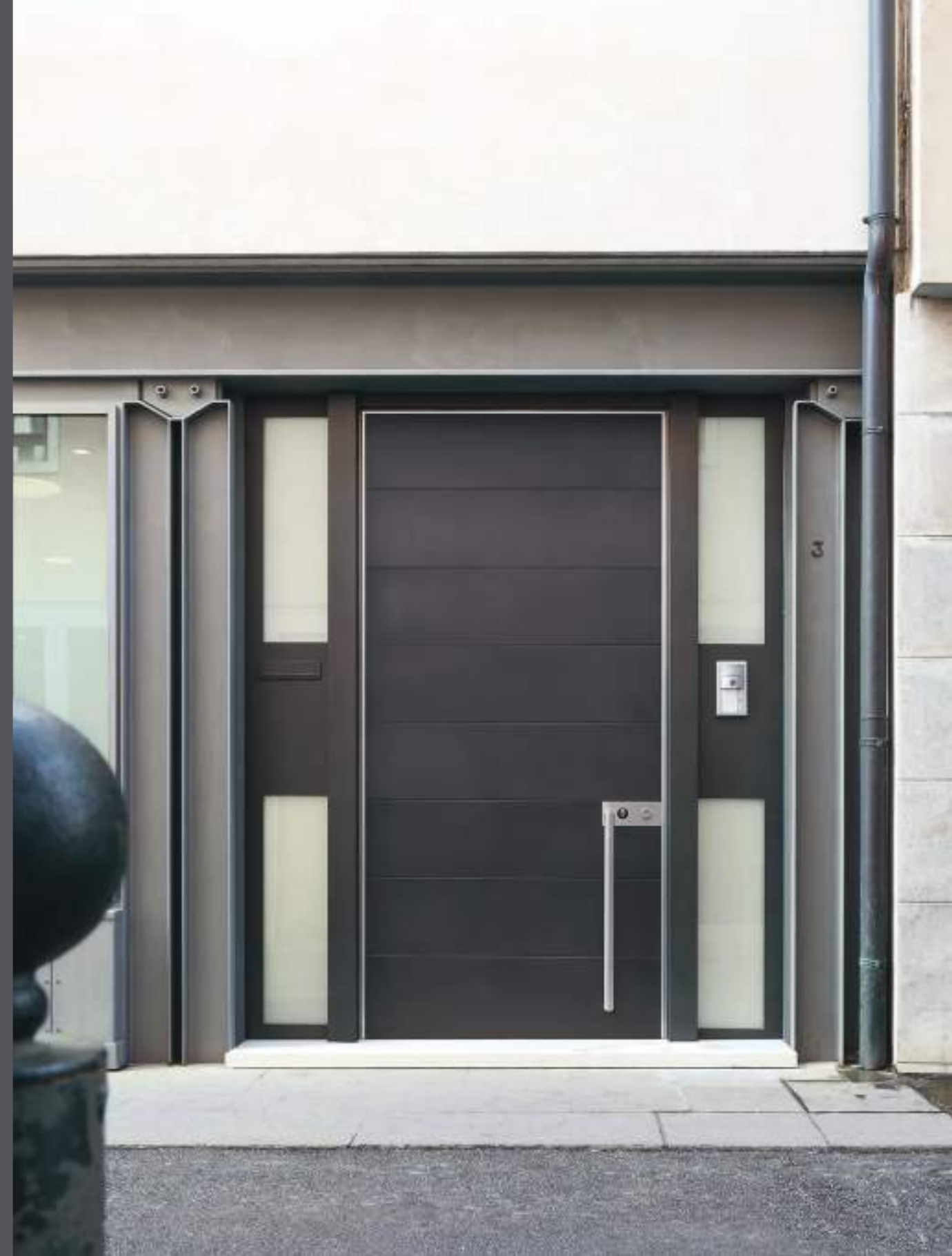
Esterno: Linea Portici a settori laccato RAL 7021 Interno: Linea Interior Design a settori laccati lucido poliester Bianco Montaggio su struttura metallica esistente, Serratura con sistema elettronico motorizzato ArcKey
