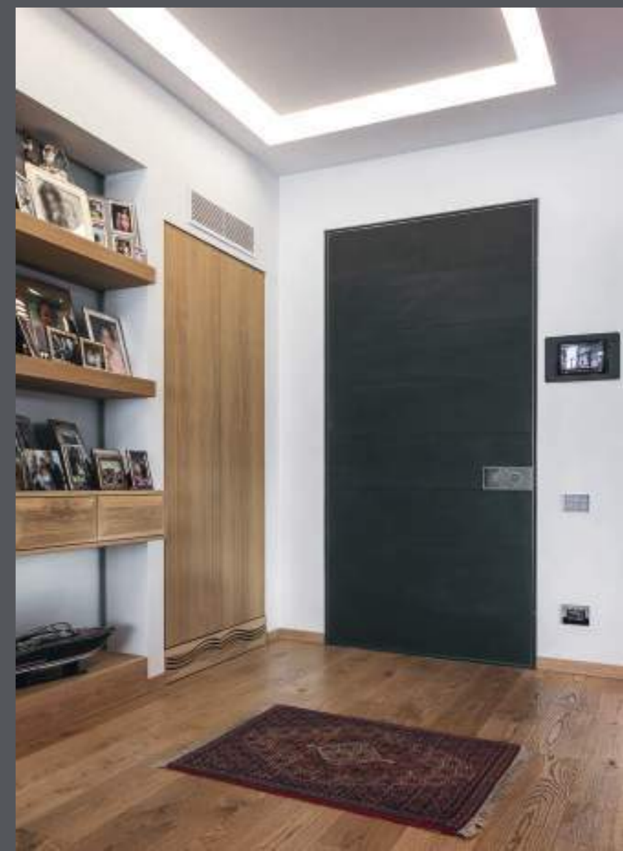
Esterno: Pannello unico personalizzato in lamiera CorTen Interno: Linea Interior Design a settori rovere laccato ral 9005 Serratura con sistema elettronico motorizzato ArcKey, profili ed accessori finitura RAL 9005, montaggio rasomura interno
